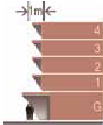
شكل (3-4) الحاجز الشمسي المستخدم لتظليل الواجهات المصدر: (مجلس أبو ظبي للتخطيط العمراني، 2009)
