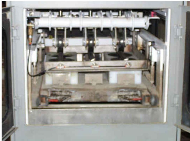
Figure 3.5. AASHTO TP63 setup
