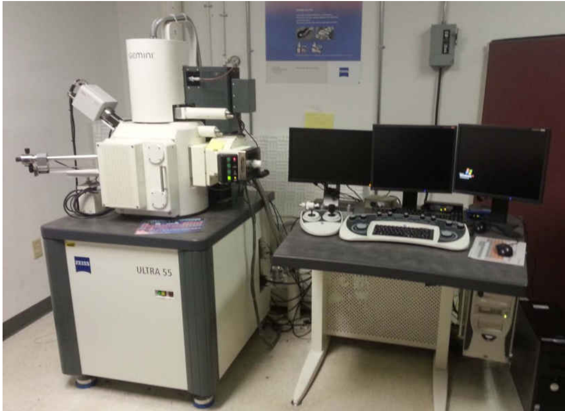
Figure 41 - Zeiss Ultra-55 SEM.
