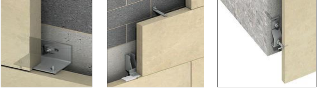
شكل (2-7): تفاصيل توضيح تثبيت الحجر على الواجهات الخارجية .
