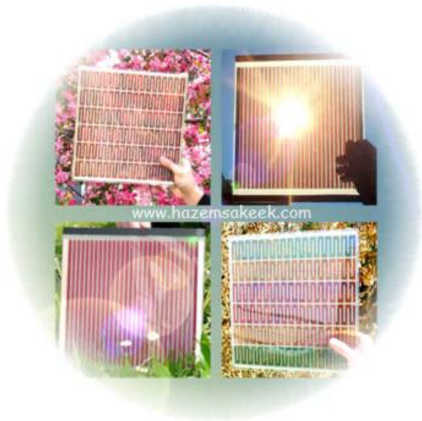
شكل (3-5) مجموعة من الخلايا الشمسية بتقنية الصبغات العضوية (سكيك، 2013)
