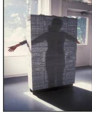
شكل (2.4): الخرسانة الممّرة للضوء
