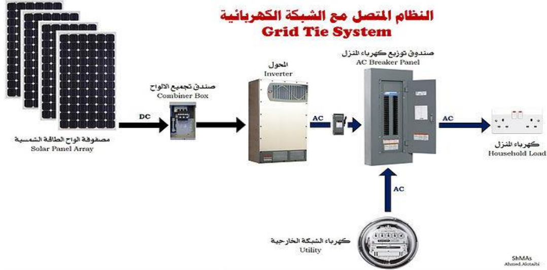
شكل (10.3): النظام الشمسي المرتبط مع الشبكة
