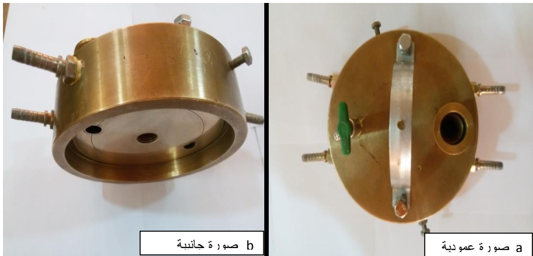
الشكل (4-3) يبين صورة عمودية وجانبية لشفة الربط العليا
