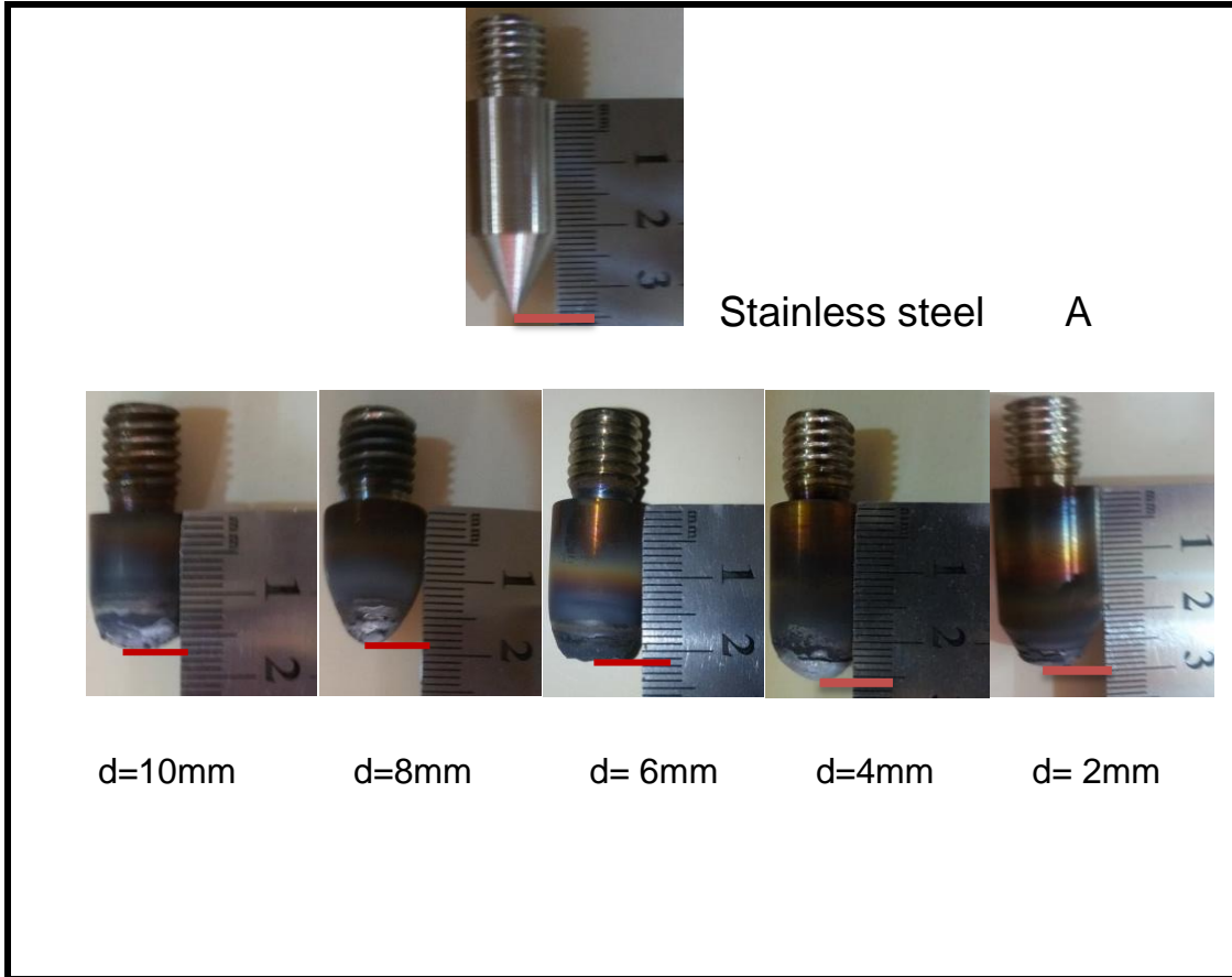
الشكل (4-19) (A) صور للاقطاب المستعملة قبل وبعد التفريغ القوسي لغاز CO 2 للكاثود المصنوع من الحديد القاروم للصدأ
