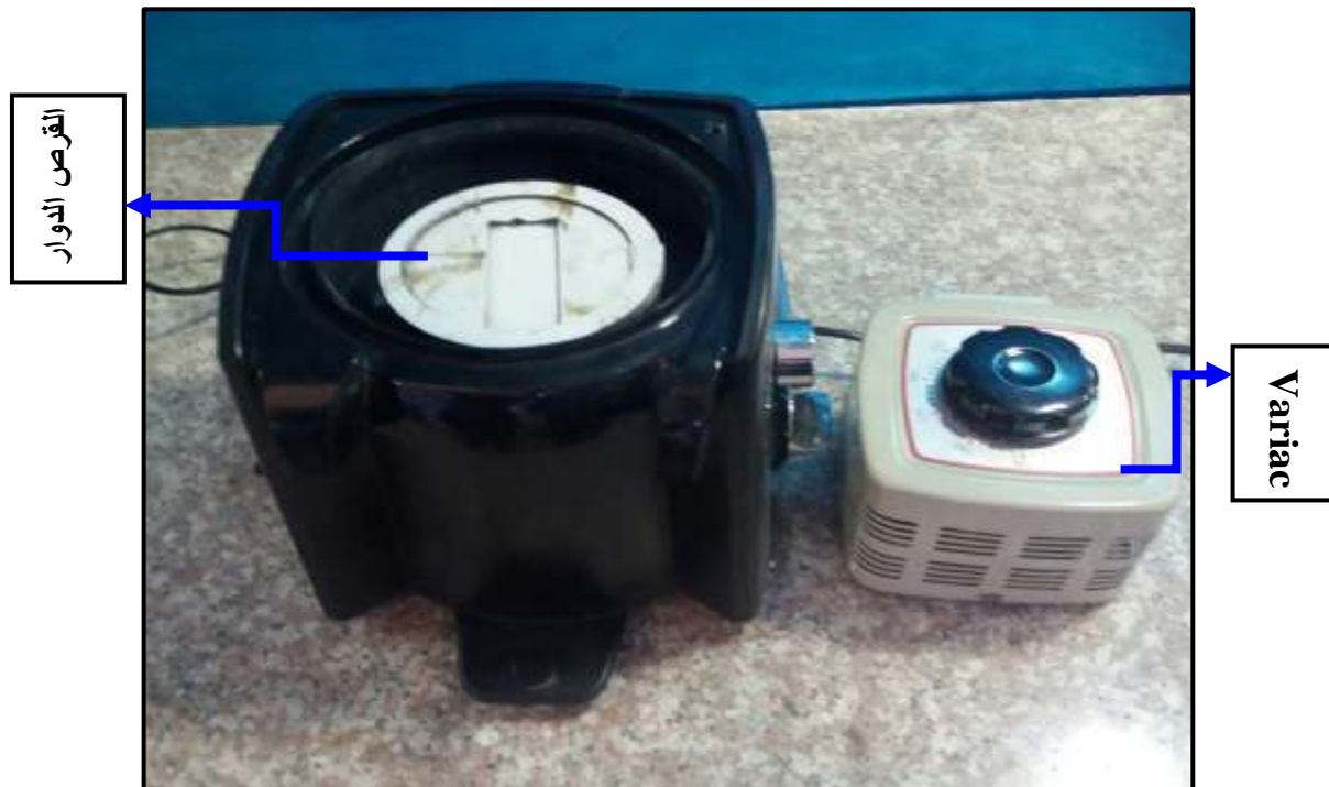
الشكل (2 - 3) صورة توضح منظومة التغطية المغزلية
