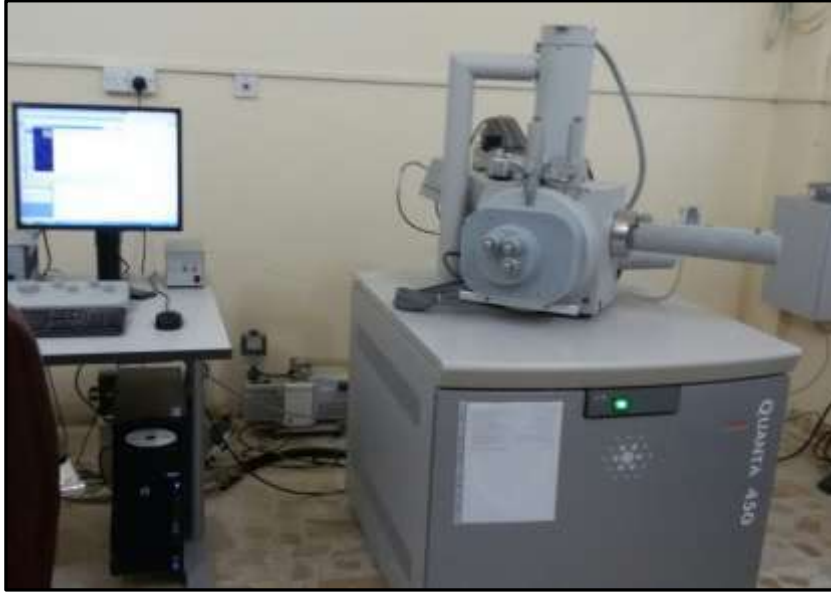
الشكل (3-4) صورة جهاز المجهر الإلكتروني الماسح (SEM)
