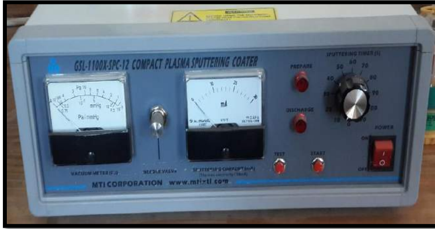
الشكل (3-5) يمثل أجهزة قياس الضغط، والتيار، وعدّاد الزمن.
