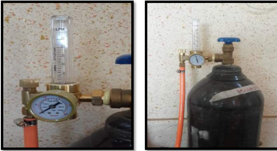
الشكل (4-3) يمثل أسطوانة غاز الأركون مع جهاز سيطرة التدفق .
