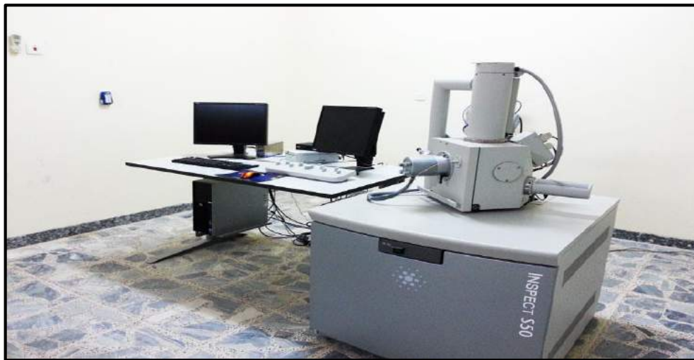
شكل (10-3) يظهر المجهر الالكتروني الماسح (INSPECT 550).
