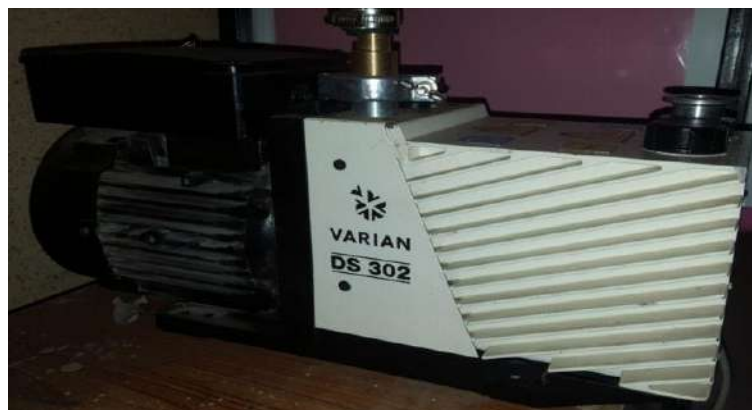
الشكل ( 3-3 ) مضخة التفريغ المستعملة لتفريغ المنظومة
