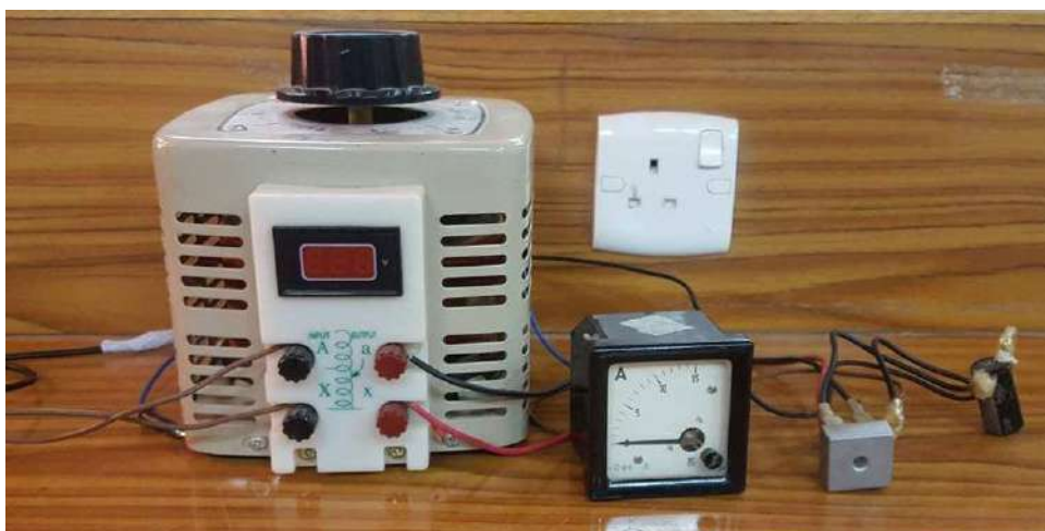
الشكل ( 13-3 ) فرياك مع قنطرة لتجهز الملف بالتيار المستمر
