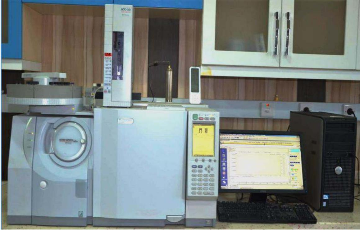
صورة 2: جهاز كروماتوغرافيا الغاز المتصل بمطياف الكتلة (GC-MS)
