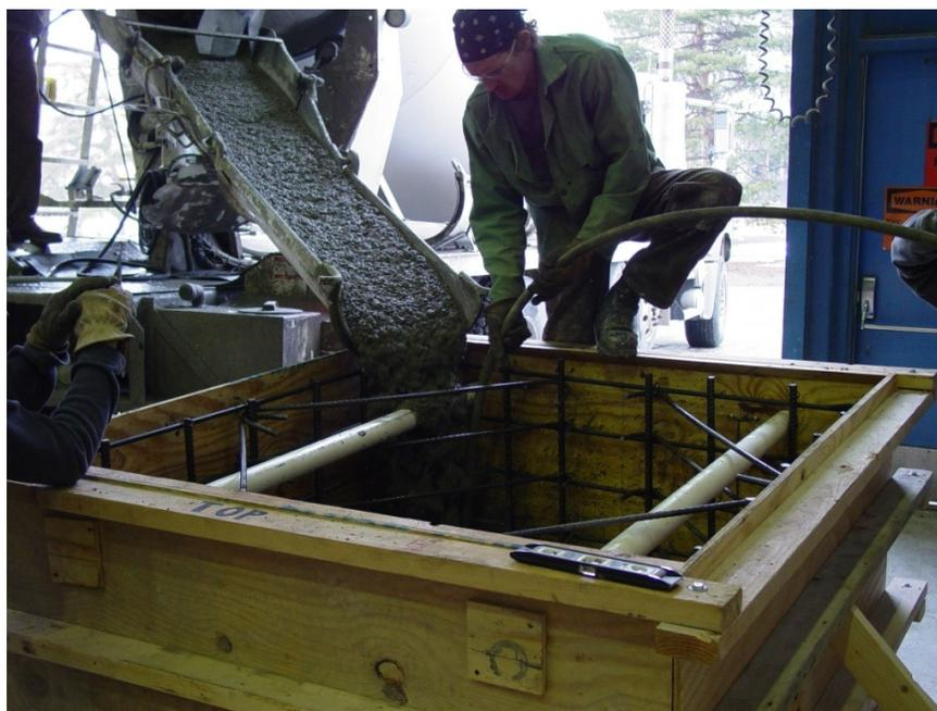
**Figure 4-13- First pour into Specimen #2**
