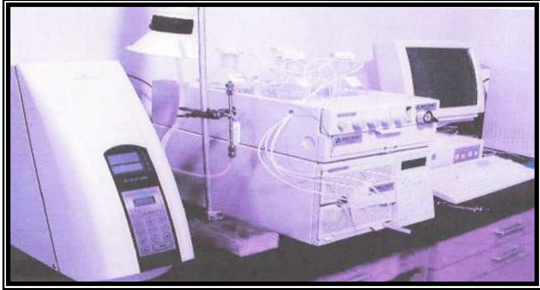
شكل (٣-٥) جهاز كروماتوغرافيا السائل ذو الأداء العالي HPLC
