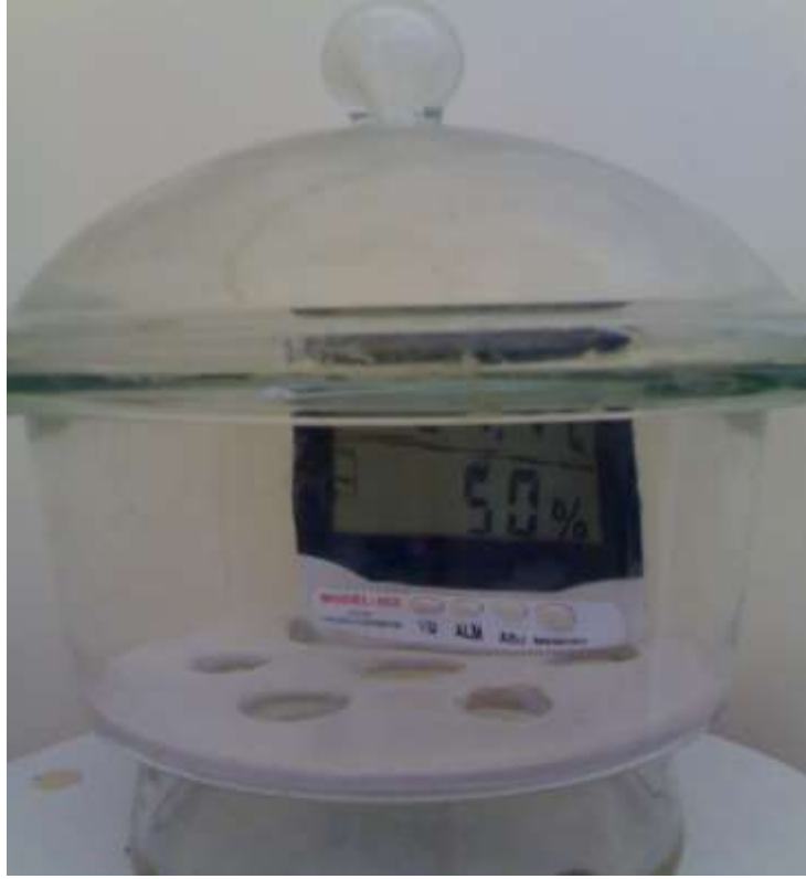
شكل (٣-٤) مجفف ويداخله جهاز قياس الرطوبة النسبية watch hygrometer
