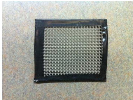
Inner Layer (porous metal)
