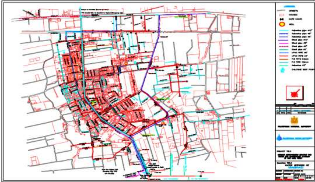
شكل (1.2): مخطط شبكة المياه لمخيم المغازي (3)
