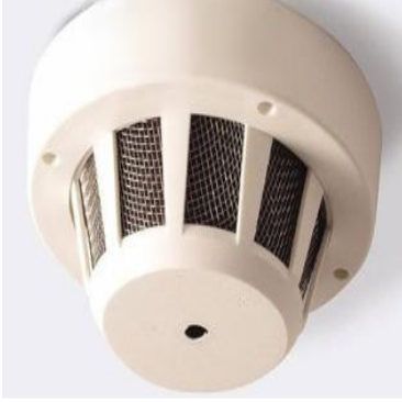
كاميرا داخل جهاز إنذار حريق-شكل (2)
