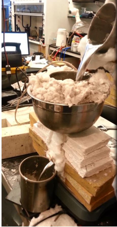
Fig. 60: Sn elbow minor loss test pour procedure
