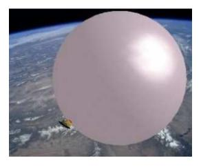
Figure 13. GOLD Drag Brake Concept<sup>14</sup>
