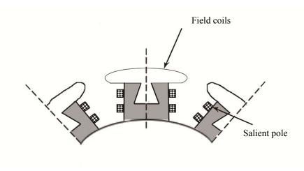
Figure (2.3): A salient pole rotor
