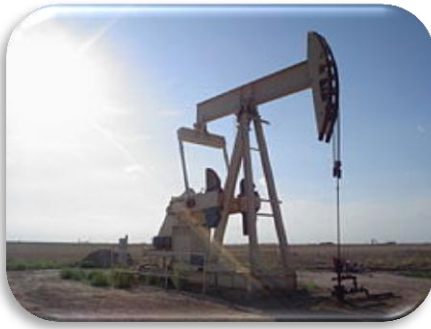
شكل 5 مضخة ميكانيكية لاستخراج النفط
