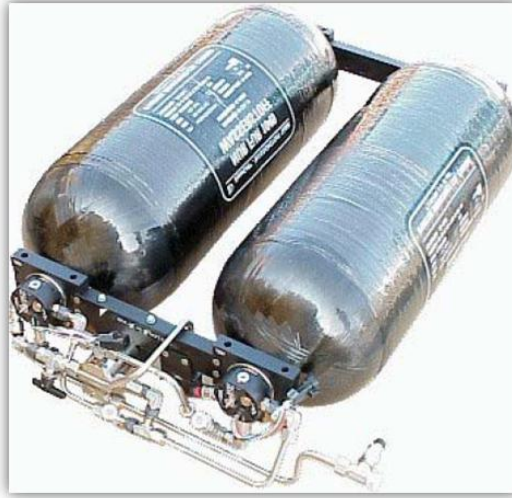
شكل 33 خزان وقود مستعمل في السيارات الهيدروجينية
