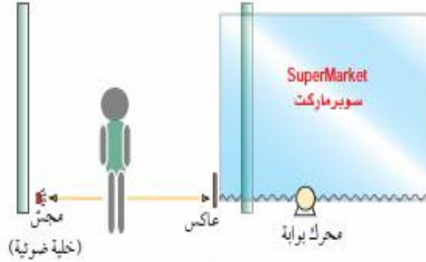
الشكل (٥): التحكم الأوتوماتيكي بفتح الباب وغلقه.
