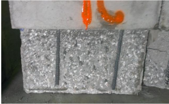
b) Bond interface (substrate concrete)
