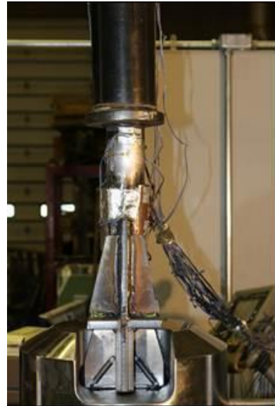
(d) Out-of-plane rotation of the bottom tube
