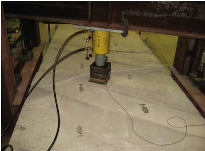
b) test setup for closure pour ultimate load test
