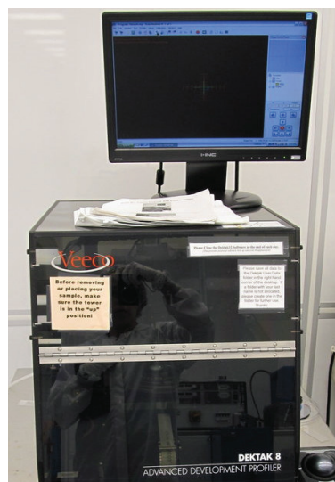
Figure 3.6 Veeco Dektak 8 Profilometer
