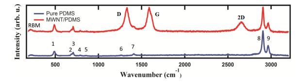
Figure 3.3 Raman spectra of the pure PDMS and the 1 wt. % MWNT/PDMS sample.
