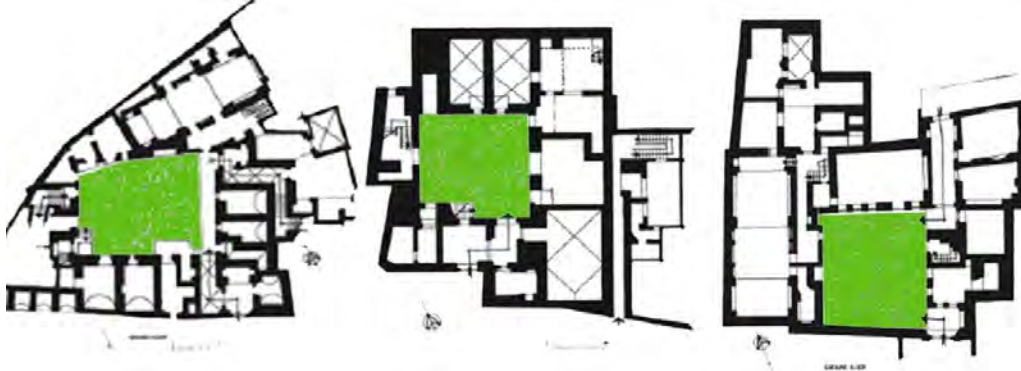
شكل ( 4-1 ) : أنماط مختلفة لإحاطة الحديقة ( أفنيه ) بالجدران و الأبنية ،لثلاثة منازل بالقاهرة، المصدر: ( Salama ,2006,P: 42 )
