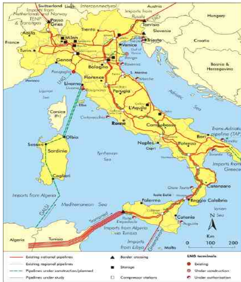
Map 3: Italy's natural gas and LNG infrastructures
