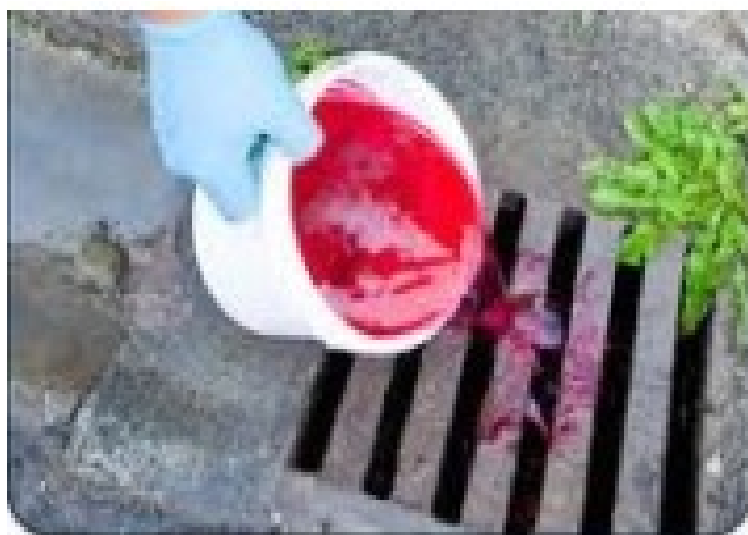
Kuva 3. Punaista väriainevettä kaadetaan hulevesikaivoon. (Drains IOM).
