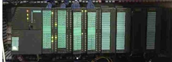
Figure 38-Test PLC-Siemens S7
