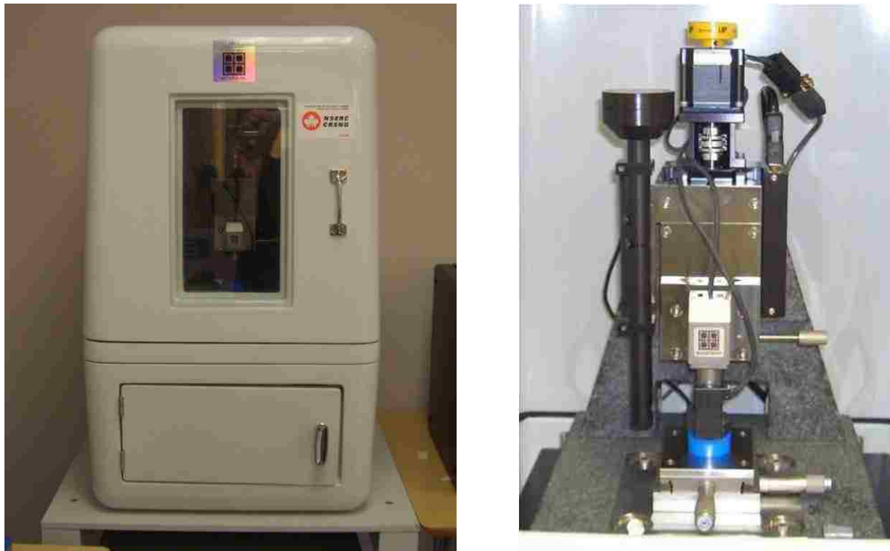
Figure 3.7: Hysitron TI 700 Ubi nano indenter
