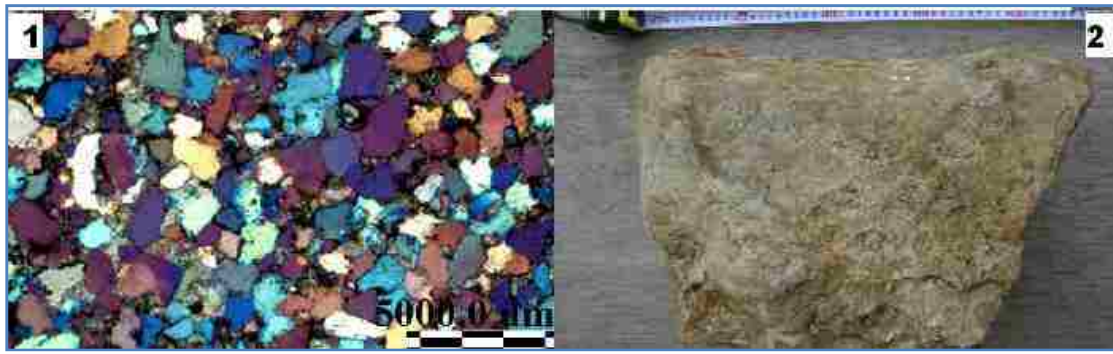
شكل رقم 48: العينة "F" الحجر الرملي الكوارتزي
