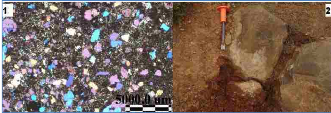
شكل رقم 46 : العينة " E " حجر رملي 1: صورة للحصى الخام 2: صورة بيتروغرافية بالضوء الإشعاعي LP
