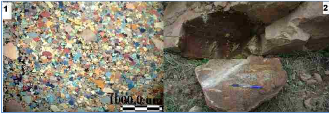
شكل رقم 45: العينة "D" حجر رملي 1: صورة بيتروغرافية بالضوء الإشعاعي 2: صورة للحصى الخام LP
