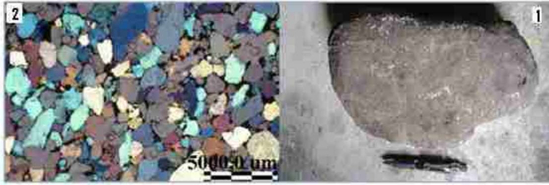
شكل رقم 44 : العينة "C" حجر رملي 1: صورة للحصى الخام، 2: صورة بيتروغرافية بالضوء الإشعاعي LP
