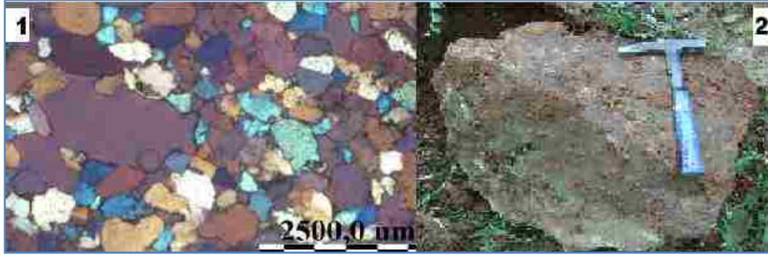
شكل رقم 49 العينة "G" الحجر الرملي الكوارتزي، 1: صورة بيتروغرافية بالضوء الإشعاعي 2: صورة للحصى الخام LP
