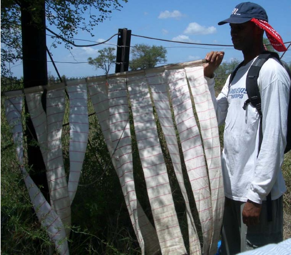
Fig. 3.3. Tick drag apparatus.
