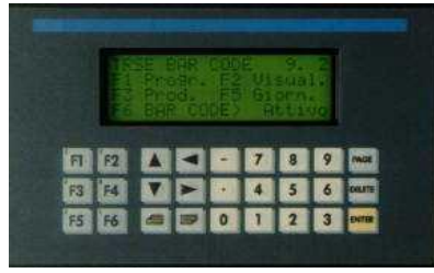
شكل (2.11): شكل وحدة HMI
